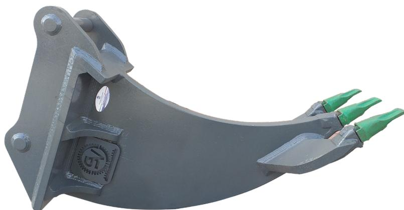
Costruito in materiale anti usura pantografato e rinforzato nei punti di maggior sollecitazione a 3 punte con lama di larghezza complessiva 600 mm. Con capsule interscambiabili con sella predisposta per attacco rapido ed altezza sottosella 1.100 mm ( Misure personalizzate)
